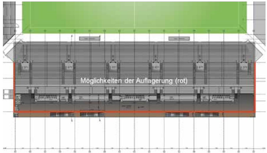
Bild 2: Grundriss der Ost-Tribüne mit Auflagerlinien in Rot
